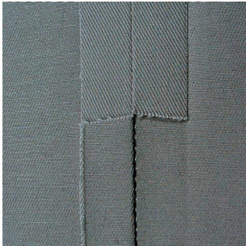
Der Dreifach-Geradstich ist besonders für strapazierfähige Nähte und für harte und dichte Stoffe wie Jeansstoff und Cordsamt geeignet. Bei harten oder sehr dicht gewobenen Stoffen empfiehlt es sich, den Jeansfuss Nr. 8 (Sonderzubehör) zu montieren. Dies erleichtert das Nähen von Jeansstoff oder Segeltuch. Für das dekorative Absteppen kann zusätzlich die Stichtlänge vergrößert werden.
