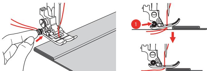
Um den Nähfuß beim manuellen Zuführen und Nähen zur gefalteten Seite hin zu unterstützen, ist es auch möglich, ein anderes Stück Stoff mit der gleichen Dicke auf die Rückseite der Naht zu legen.
