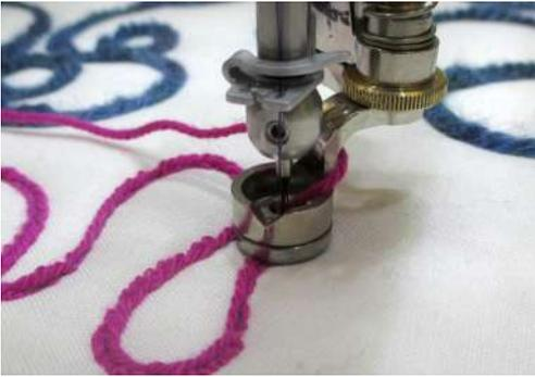
> Kordel von vorne in Nährichtung führen (Abb. 4). Bei sehr starren Kordeln, die sich leicht verzwirren oder Schlaufen bilden, Kordel hinter dem Nähfuß führen (Abb. 5). Dabei sicherstellen, dass die Kordel nicht zu hoch angestochen wird.
